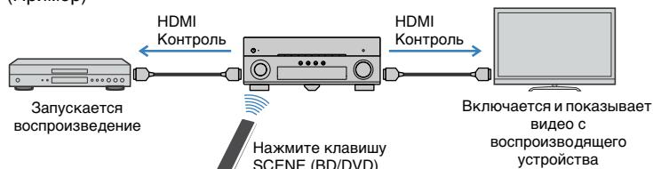
Для использования управления HDMI необходимо выполнить следующую настройку соединения HDMI Контроль после подключения телевизора и воспроизводящих устройств.
