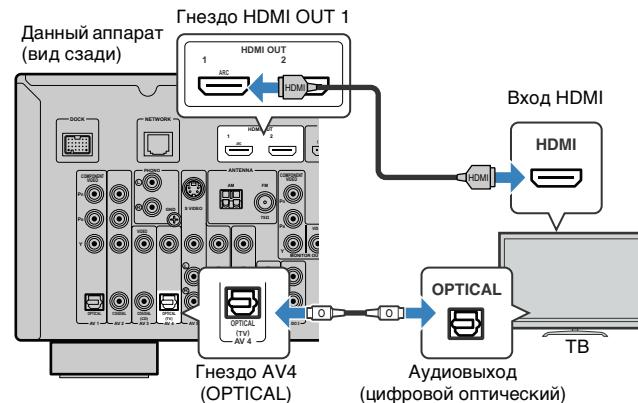
Если в качестве источника входного сигнала аппарата выбрать "AV4", нажав AV4 или SCENE(TV), звук с телевизора будет воспроизводиться на аппарате.
