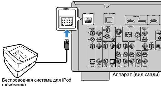
Беспроводная система для iPod
