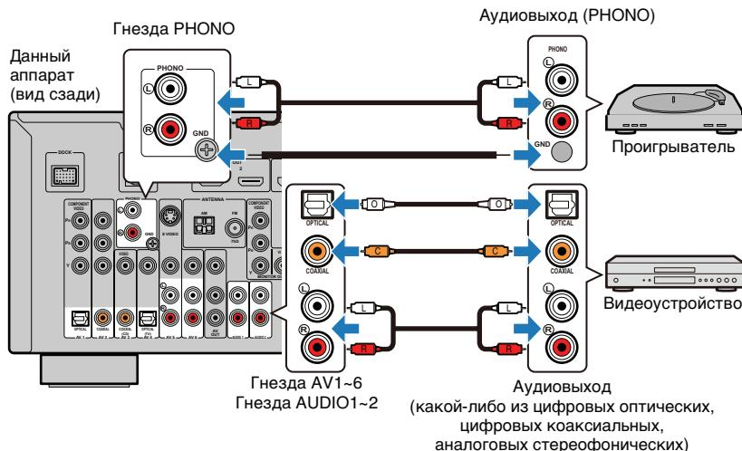
Если выбрать источник входного сигнала, нажав клавиши AV1~6, AUDIO1~2 or PHONO, аудиосигнал, который воспроизводится на аудиоустройстве, будет выводиться через аппарат.
