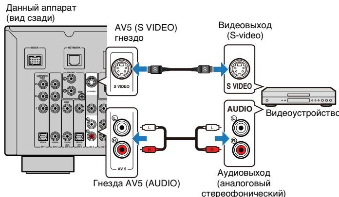
Если в качестве источника входного сигнала аппарата выбрать AV5, видео/аудиосигнал, который воспроизводится на видеоустройстве, будет выводиться через аппарат.
