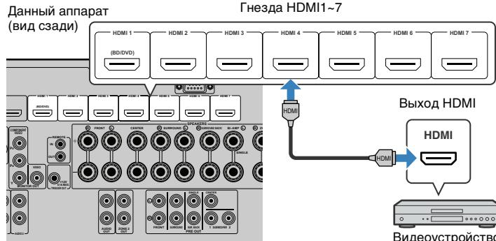
Если в качестве источника входного сигнала аппарата выбрать HDMI1~7, видео/аудиосигнал, который воспроизводится на видеоустройстве, будет выводиться через аппарат.
