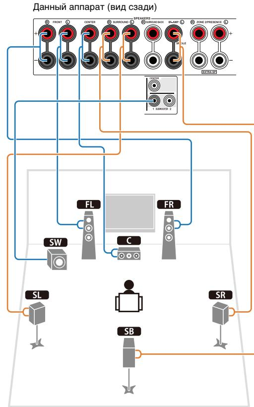
Если используется только одна тыловая колонка окружающего звучания, подключите ее к гнезду SINGLE (слева).
