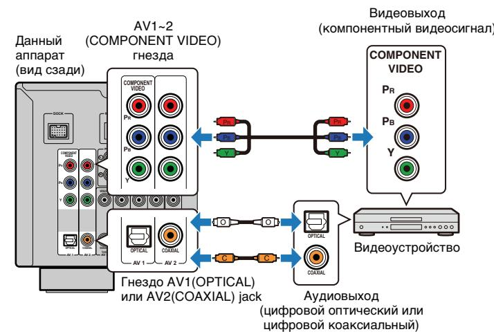
Если в качестве источника входного сигнала аппарата выбрать AV1~2, видео/аудиосигнал, который воспроизводится на видеоустройстве, будет выводиться через аппарат.
