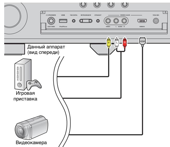
Если в качестве источника входного сигнала аппарата выбрать "V-AUX", нажав клавишу V-AUX, видео/аудиосигнал, который воспроизводится на видеоустройстве, будет выводиться через аппарат.
