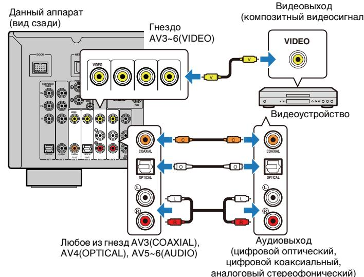
Если в качестве источника входного сигнала аппарата выбрать AV3~6, видео/аудиосигнал, который воспроизводится на видеоустройстве, будет выводиться через аппарат.
